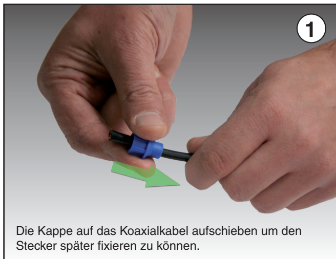
1.) Schutzkappe aufschieben
